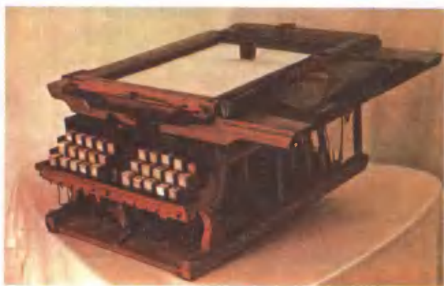
Одна из пишущих машинок, сконструированная в 1864 году. Сходство с более поздними конструкциями, пожалуй, только в расположении клавиш...
